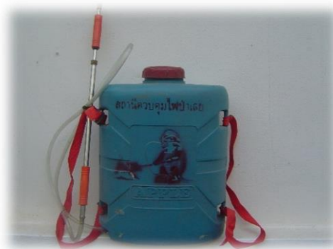
ภาพที่ ๔.๒ ถังฉีดน้ำ
