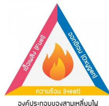
ภาพที่ ๑.๑ องค์ประกอบของสามเหลี่ยมไฟ
