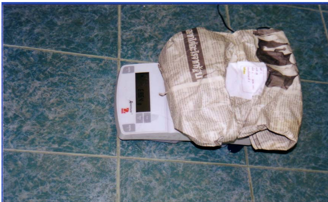
ภาพที่ 7 การชั่งน้ำหนักเชื้อเพลิงตัวอย่างด้วยเครื่องชั่ง scale สะเอียด
