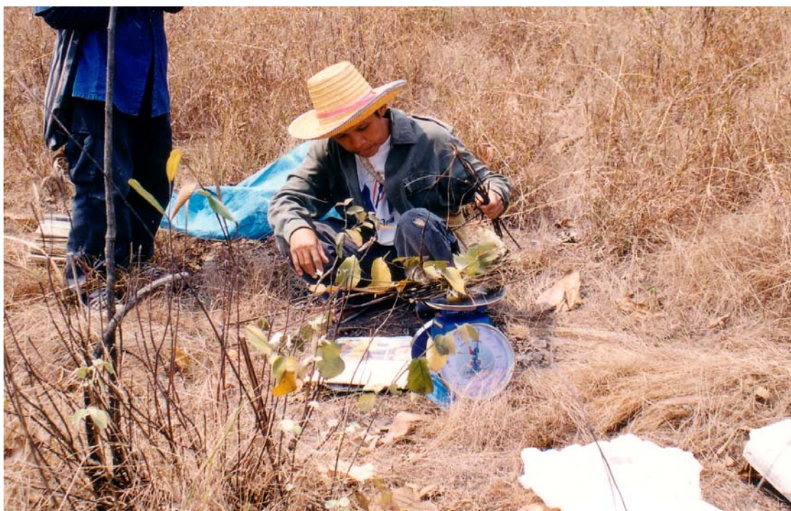
ภาพที่ 6 การชั่งน้ำหนักสดของเชื้อเพลิงในแปลงเก็บตัวอย่าง ด้วยเครื่องชั่ง scale หยาบ
