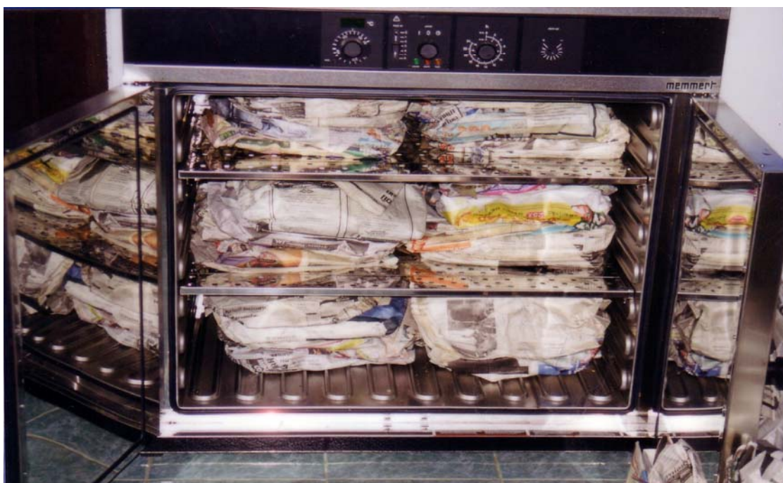
ภาพที่ 8 การอบเชื้อเพลิงตัวอย่างเพื่อหาน้ำหนักแห้ง
